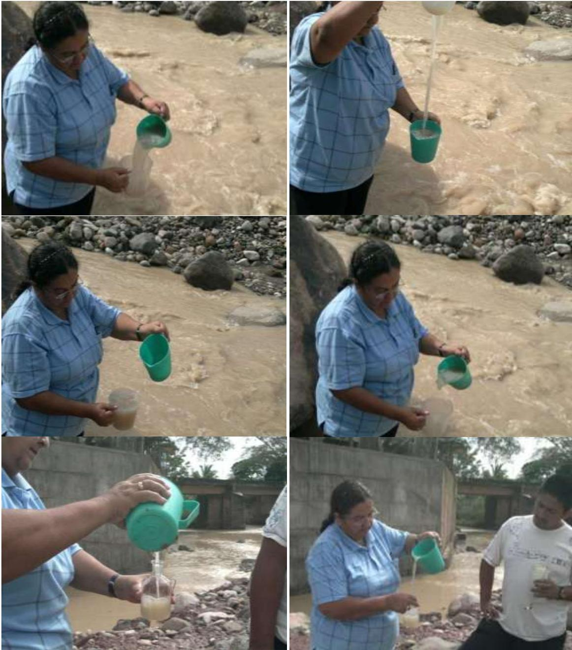
Figura 73. Toma de muestras para el análisis de turbiedad en la parte baja del río Timaná
