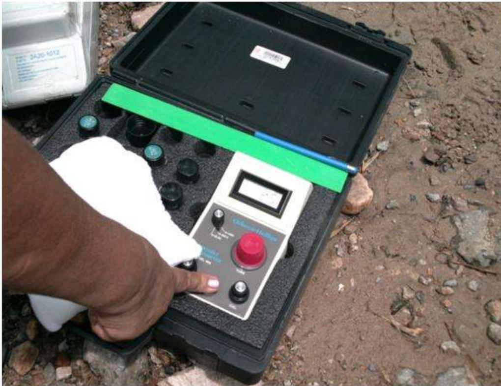
Figura 72. Determinación de la turbiedad del agua en la parte baja del río mediante el uso del turbidímetro
