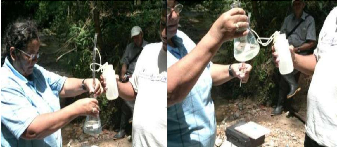
Figura 69. Análisis en campo del Oxígeno Disuelto en la muestra de la parte media del río Timaná
