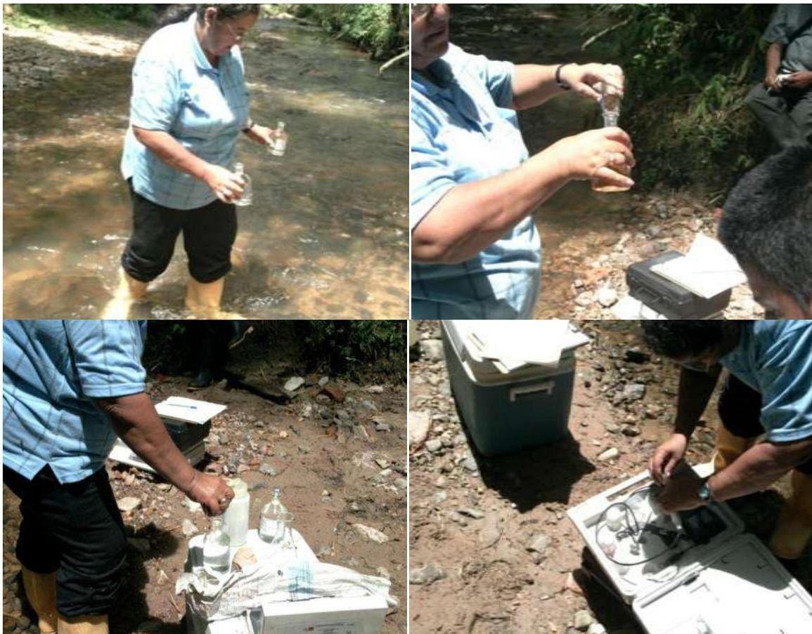
Figura 67. Alistamiento de las muestras y de los implementos para determinar el DBO5 en la parte media del río Timaná
