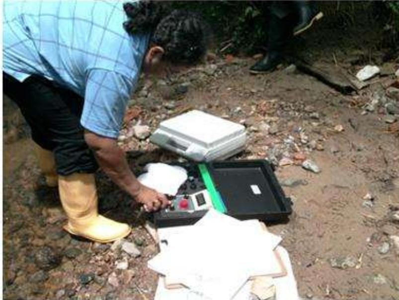
Figura 66. Medición de la turbiedad del agua en la parte media del río Timaná mediante el uso del turbilímetro
