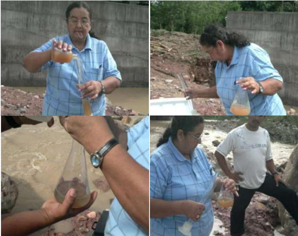
Figura 75. Análisis de la muestra de agua de la parte baja del río Timaná para determinar el DBO5
