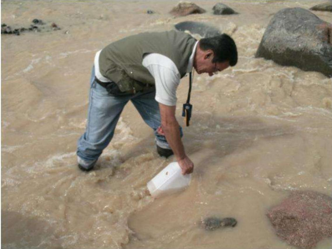
Figura 58. Toma de la muestra del agua en la parte baja del río para procedimientos de laboratorio vereda La Palma
