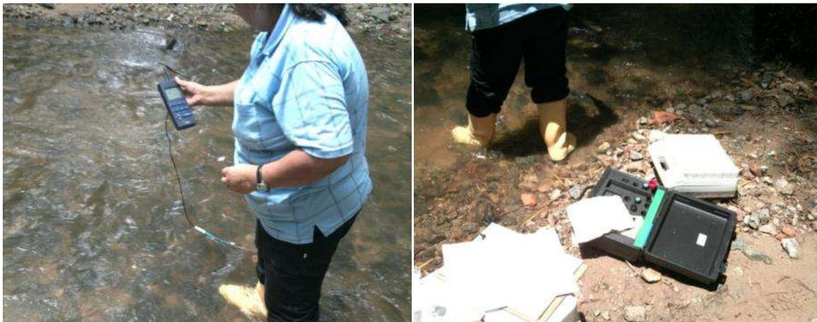
Figura 64. Toma de temperatura del agua y lectura del pH en campo en la parte media del río, parte media río Timaná
