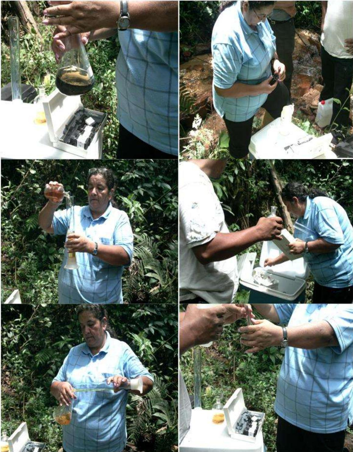
Figura 61. Procedimiento de aplicación de reactivos para determinar el DBO5 en la muestra de la parte alta del río Timaná
