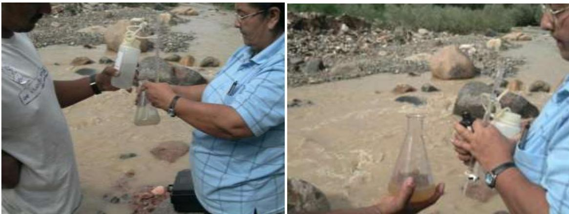
Figura 76. Preparación para el análisis del oxígeno disuelto en la muestra de la parte baja del río Timaná
