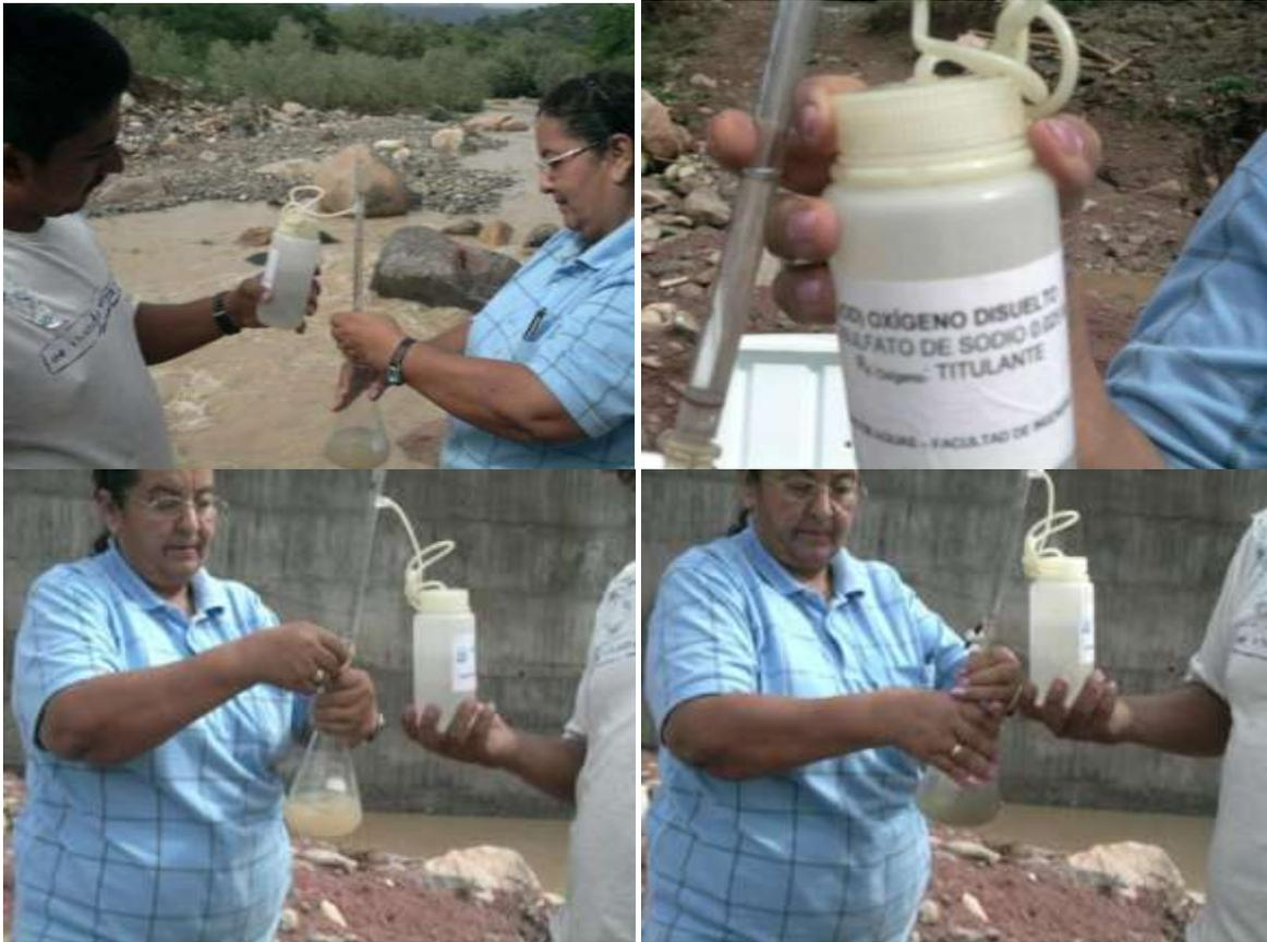
Figura 77. Análisis del oxígeno disuelto en la muestra de agua de la parte baja del río Timaná
