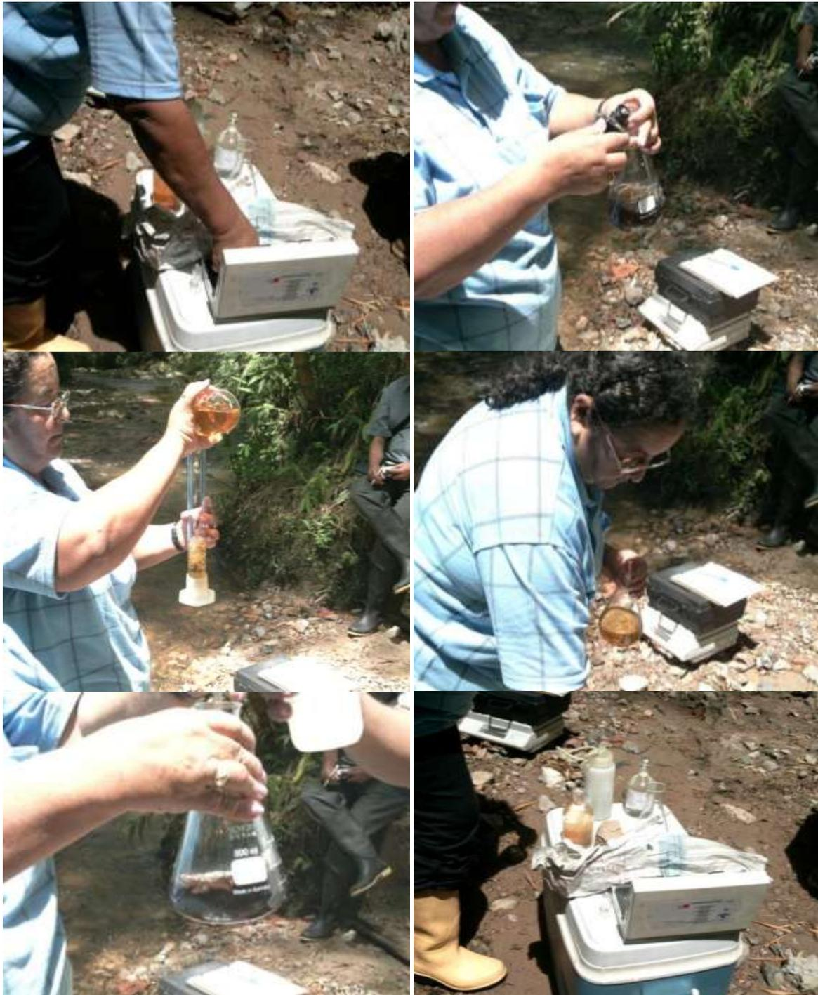
Figura 68. Procedimiento para determinar el DBO5 en la pare media del río Timaná
