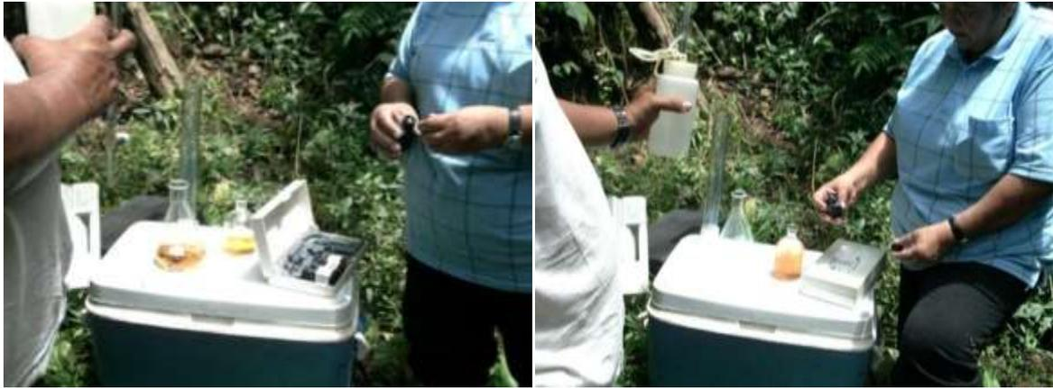
Figura 62. Procedimiento para determinar en campo el Oxígeno Disuelto, en la muestra de la parte alta del río Timaná
