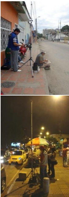
Medición de ruido ambiental a 4 metros de altura (Franjas Horarias Diurna y Nocturna).
