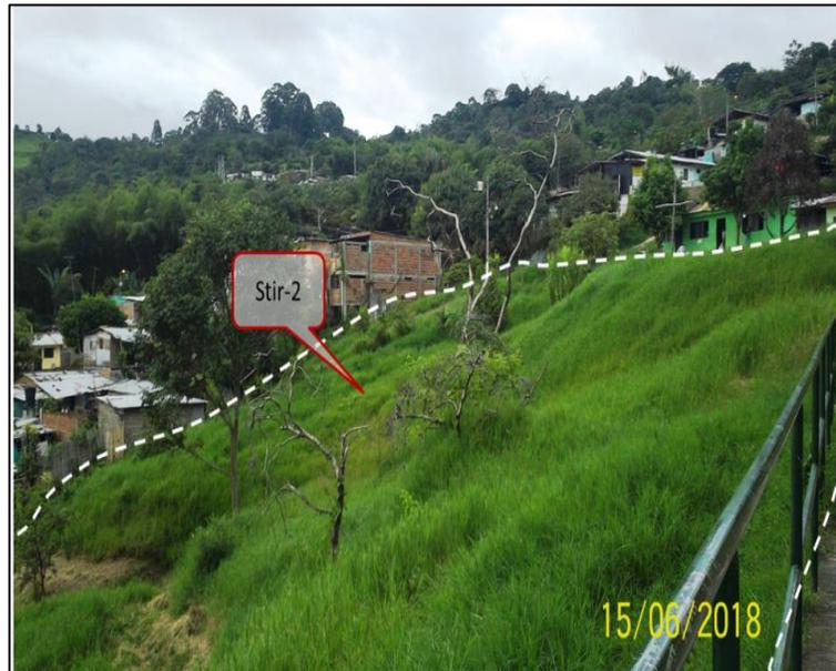
**Ilustración 21. Suelo traslocado de inestabilidad reciente (Stir-2) en un deslizamiento rotacional contiguo a la catedral**
