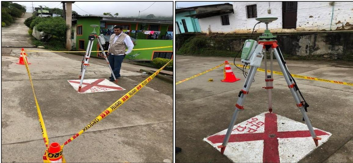
**Ilustración 4. Procedimiento en campo toma de GCP.**
