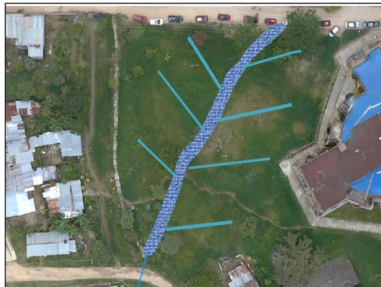
**Ilustración 200 Localización en planta de las trincheras drenantes, dispuestas en espina de pescado.**
