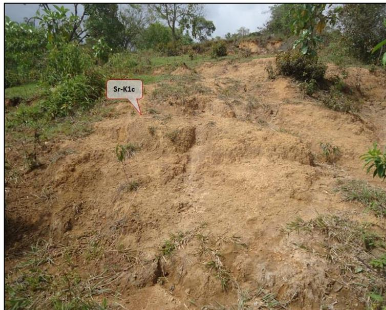
**Ilustración 16. Suelo residual sedimentario de la Formación Caballos (Srs-K1c)**
