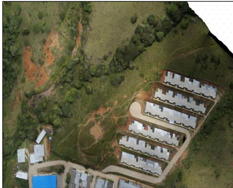
**Ilustración 117. Vista en planta del área del Barrio Nuevo, afectado por la erosión hidria sobre los taludes de corte.**
