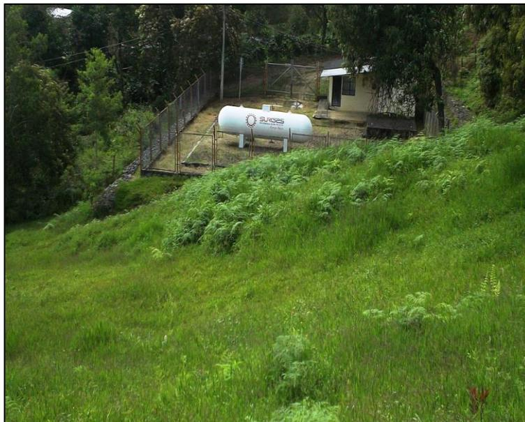
**Ilustración 211. Movimiento superficial tipo reptación hacia el extremo nororiental de la zona de estudio. Nótese las ondulaciones en la superficie del terreno, la vegetación inclinada y algunas pequeñas terracillas hacia la parte central de la Fotografía.**
