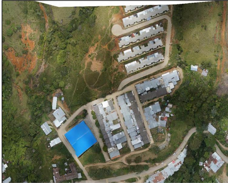
**Ilustración 216. Erosión laminar y en surcos de leve a moderada magnitud en un talud realizado para la adecuación de terrenos para construcción de viviendas en la zona de expansión de Nátaga.**
