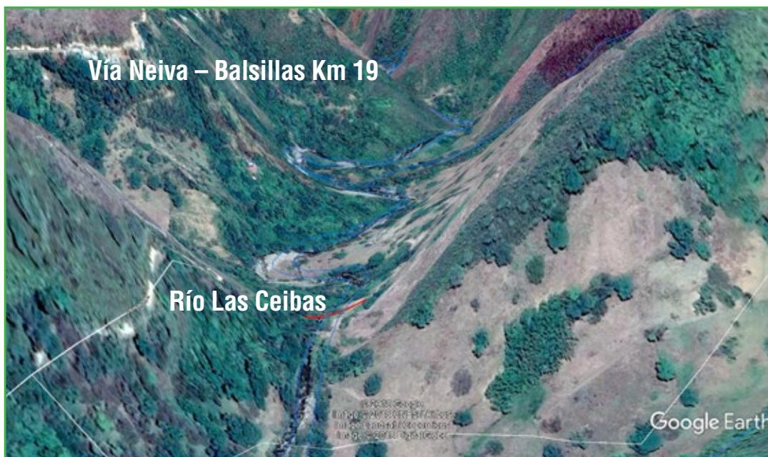
Ubicación de la malla a construir. La línea roja corresponde a la malla UX180-H6-Espec, que se ubica sobre el río Las Ceibas, paralelo al Km 18 de la vía Neiva – Balsillas.
