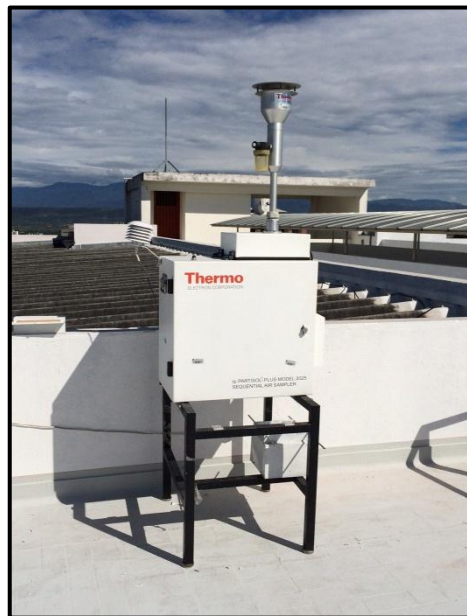
Equipo Thermo Partisol 2025 - PM 10 en la estación CORHUILA PRADO ALTO
