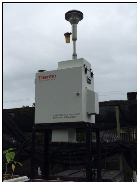
Equipo Thermo Partisol 2025 - PM 10 en la estación CAM NORTE
