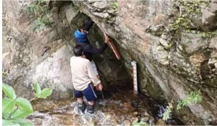
Instalación de regleta en estación Las Juntas, Rio Frio – Municipio de Rivera
