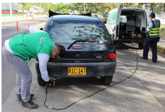
Foto: Equipo de medición de contaminantes por fuentes móviles, Banco de gases y Opacímetro
