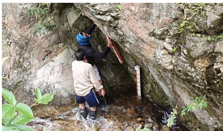
Instalación de regleta en estación Las Juntas, Río Frío – Municipio de Rivera
