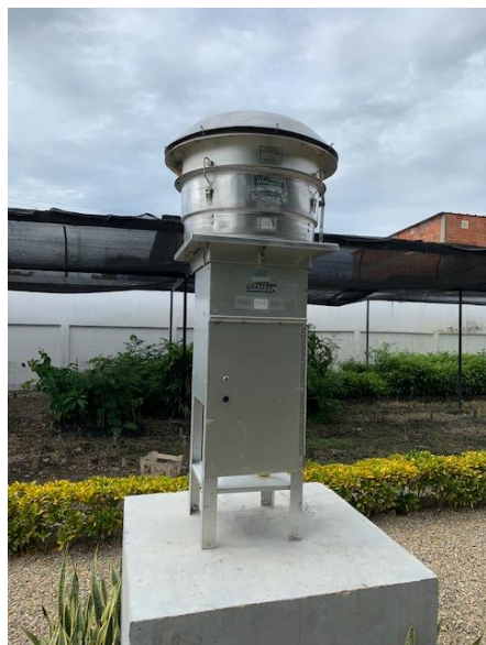
Equipo monitoreo de partículas PM 10 en la estación CAM NORTE
