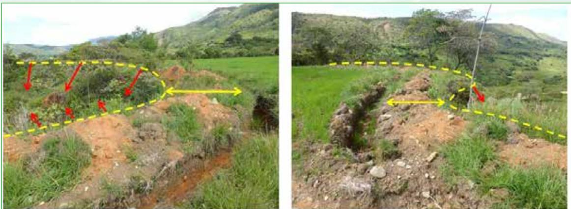
Fotografías que muestran la poca distancia entre los canales que transportan agua de un cultivo de arroz y la corona de un Fenómeno de remoción en masa (Finca La Chapa, vereda Estambul, Teruel).
