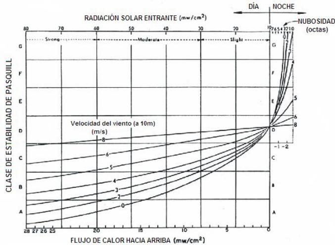
Figura 48. Nomograma para cálculo de estabilidad atmosférica según Pasquill<sup>38</sup>
