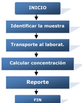
Figura 9. Pasos a realizar después de la toma de la muestra de SO<sub>2</sub> y NO<sub>x</sub>
