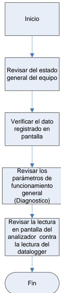
Figura 25. Proceso de revisión del analizador de óxidos de nitrógeno (NO/NO<sub>x</sub>)
