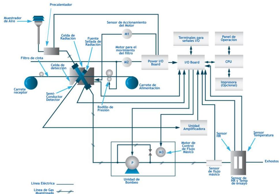
Figura 13. Esquema analizador Beta<sup>6</sup>.
