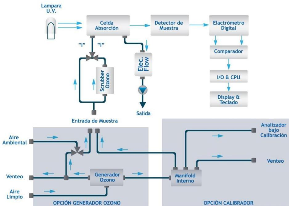
Figura 16. Diagrama de Flujo Analizador O<sub>3</sub><sup>10</sup>
