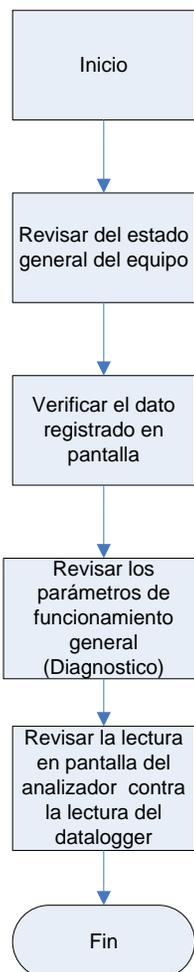
Figura 24. Proceso de revisión del analizador de dióxido de azufre (SO<sub>2</sub>)
