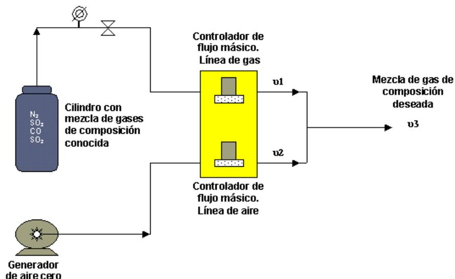
Figura 31. Principio de funcionamiento de un calibrador multigas
