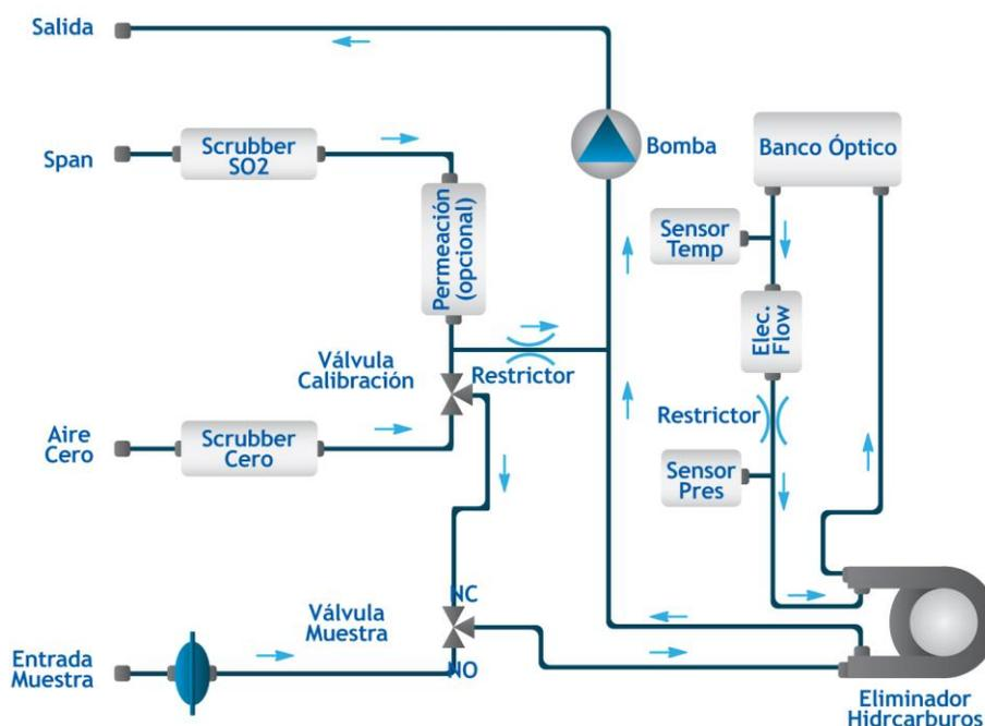
Figura 14. Diagrama de Flujo Analizador de SO<sub>2</sub>
