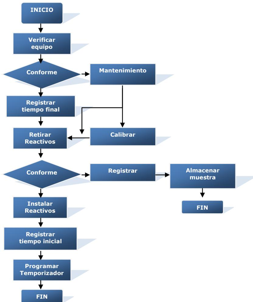
Figura 8. Pasos a realizar durante la toma de la muestra de SO<sub>2</sub> y NO<sub>x</sub>
