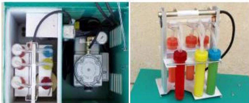
Figura 10. Equipo Muestreador de 3 Gases<sup>4</sup>
