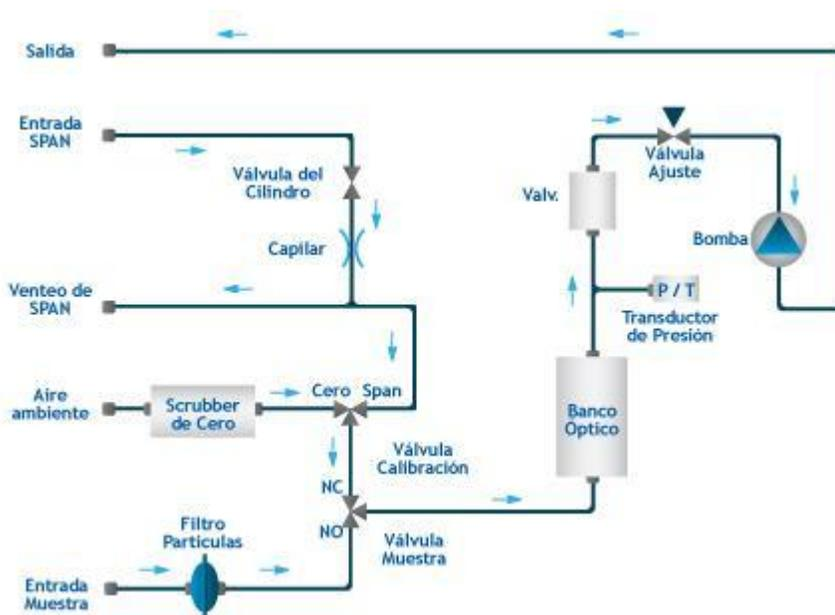
Figura 17. Diagrama de Flujo Analizador CO<sup>12</sup>
