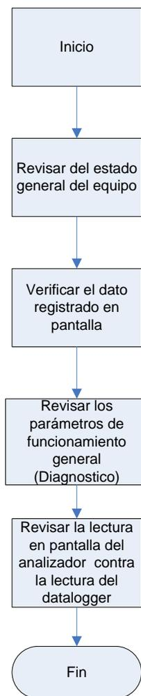
Figura 26. Proceso de revisión del analizador de ozono (O<sub>3</sub>)
