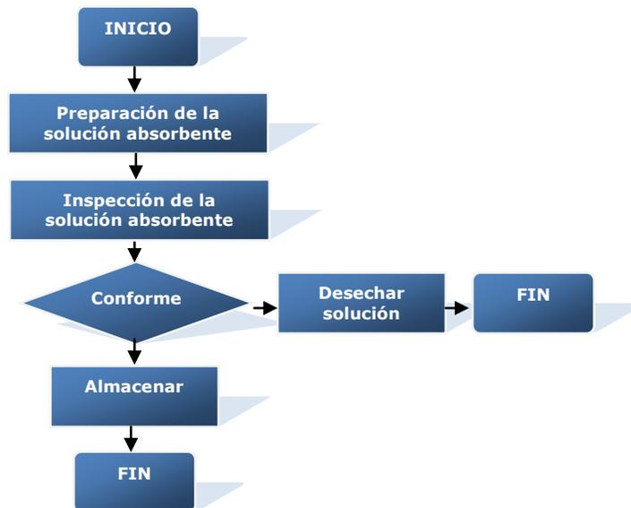
Figura 7. Pasos previos en la realización de la toma de muestras de SO<sub>2</sub> y NO<sub>x</sub>
