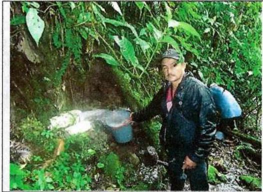
**Fotografía 7.** Aforo por método volumétrico
